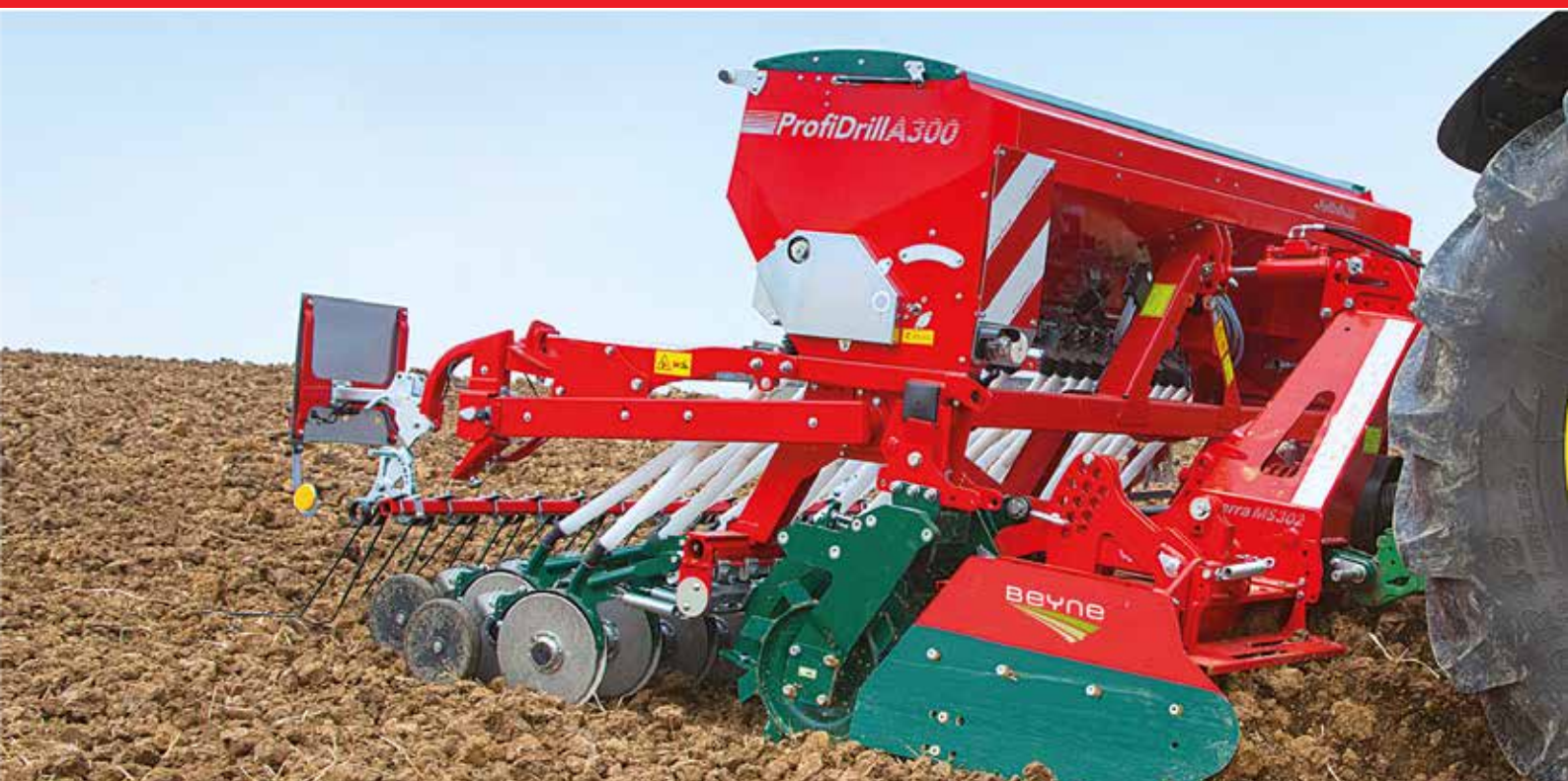
Arterra M 302 avec rouleau émietteur combinée au semoir intégré ProfiDrill A
