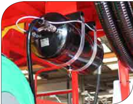
Tank met overdrukbeveiliging
