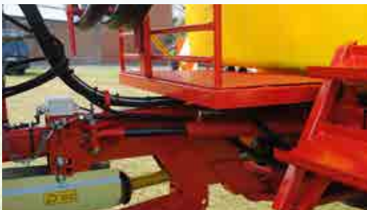
Automatische spoorvolging dankzij knikdissel m.b.v. 2 cilinders.
