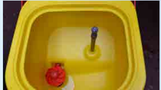
Grote capaciteit mengtank naast bedieningspaneel; ook mogelijk om gewasbeschermingsmiddelen in poedervorm snel en gemakkelijk te mengen.
