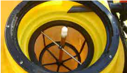
Bereikbaar mangat met fustreiniger voor het reinigen van verpakkingen; gemakkelijk te bedienen dankzij bijhorende drukregelaar.
