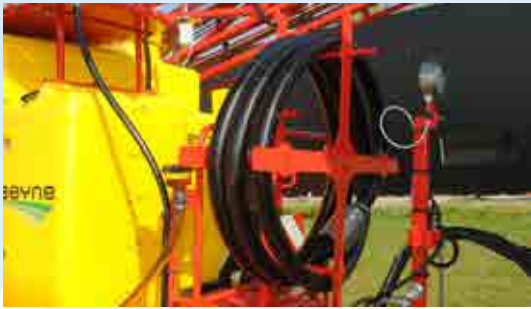
Handige oproller voor het opbergen van de zuigslang (6-8 m), manueel afrolbaar.
