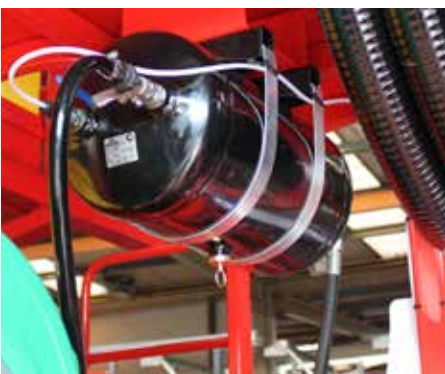
Tank mit Überdrucksicherung
