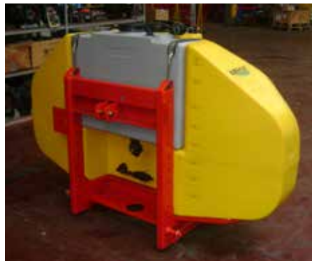
750 l Fronttank Mit Frischwassertank
