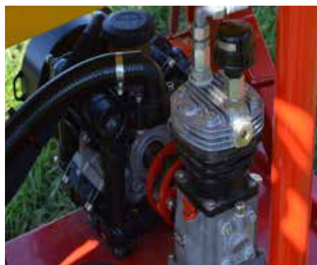
Kompressor und Pumpe
